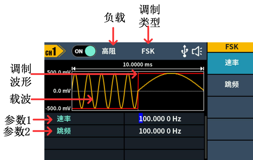
图 5-16：频移键控调制的用户界面
