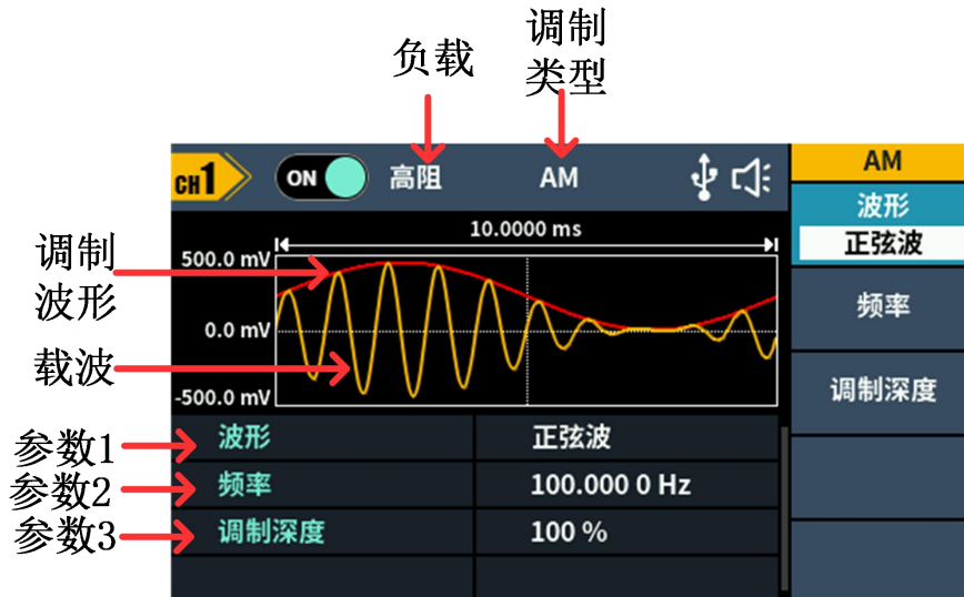
图 5-13: 振幅调制的用户界面
