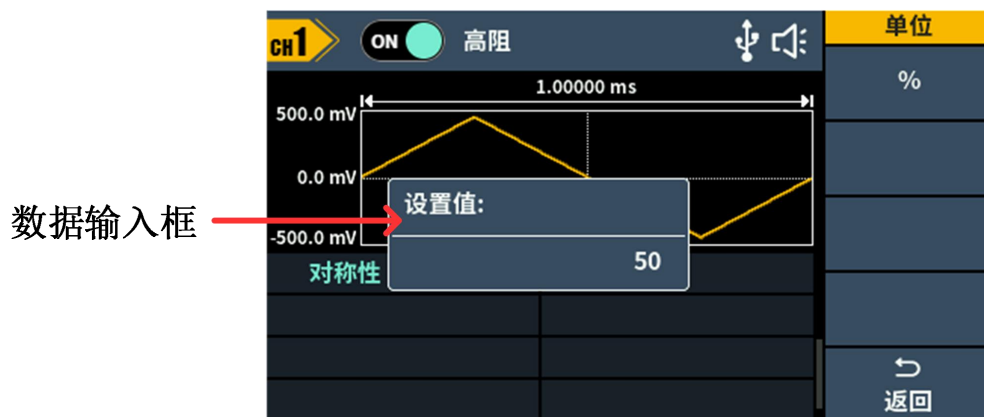
图 5-6：设置锯齿波的对称性
