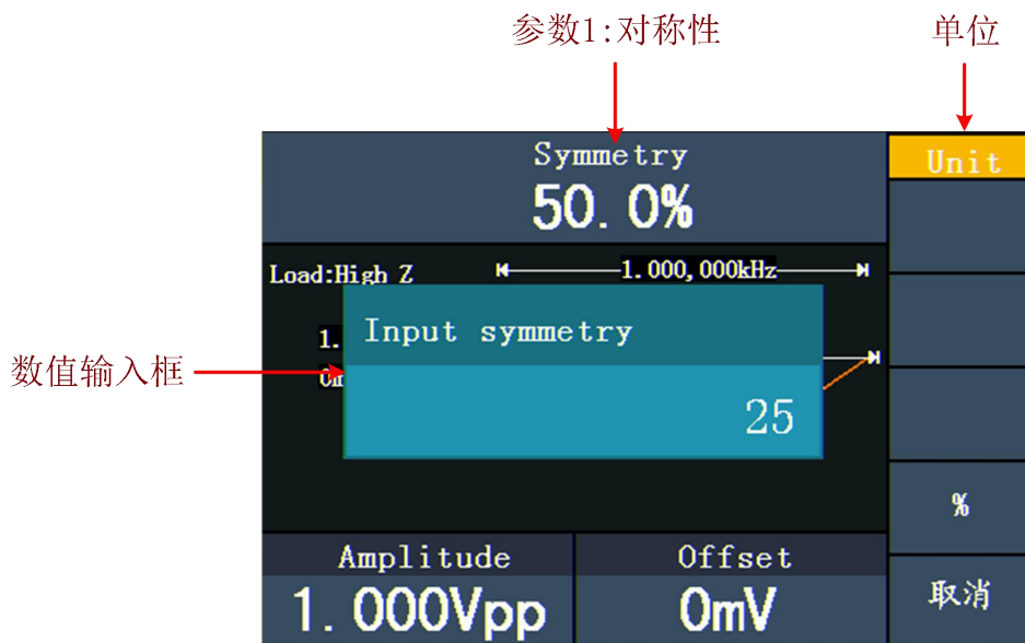
图 5-6：设置锯齿波的对称性
