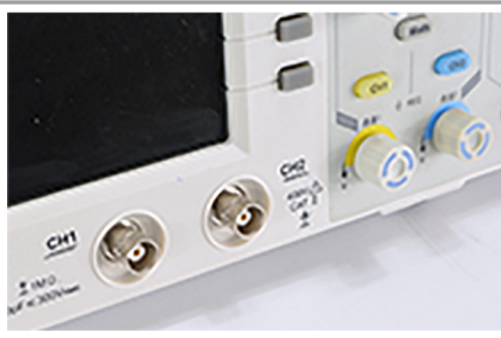
双通道输入 最大输入电压400Vpp
